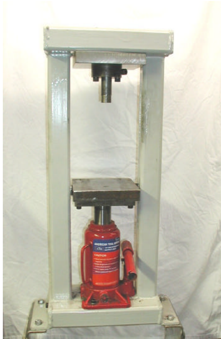
Fig. 1. 20 ton bench hydraulic press
